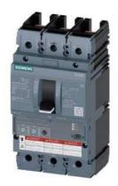
Leistungsschalter 3VA6 UL Frame 150 Schaltvermögenklasse C 100kA @ 480V 3-polig, Anlagenschutz ETU320, LI, In=150A Überlastschutz Ir=60A...150A Kurzschlussschutz Ii=1,5...10 x In ohne Anschluss
