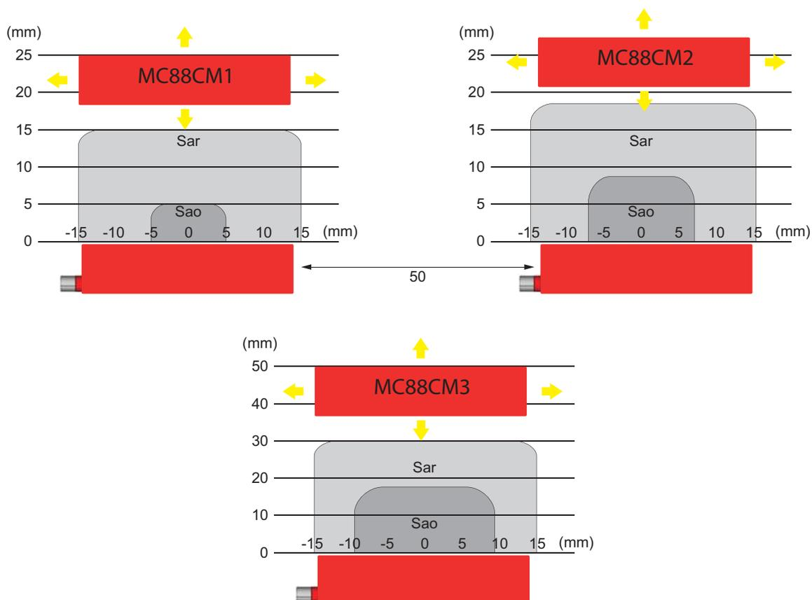
Hinweis: gezeigte typische Detektionscharakteristik kann von Sensor zu Sensor variieren.
