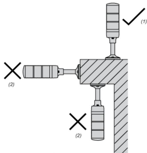
Wählen Sie eine ebene Fläche mit ausreichender Stärke und geringer Vibration für die Installation aus. Montieren Sie das Produkt gemäß der Abbildung, um die IP-Eigenschaften zu gewährleisten.
