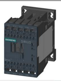
CONT. F. RAILW. A., AC-3, 5.5KW AC-3, 5.5KW/400V, 1NC, DC 12V, 0.7...1.25\*US, W. INTEGRA. SUPPRESSOR DIODE, 3POLE, SIZE S00, SPRING-LOADED TERMINAL
