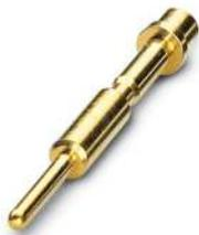
Crimpkontakt, gedreht, Kontaktdurchmesser: 1 mm, Crimpbereich: 0,25 mm<sup>2</sup> ... 1 mm<sup>2</sup>, Alternativprodukt nach RoHS II ohne Ausnahme 6c (Pb < 0,1 %) Art.-Nr.: 1243215
