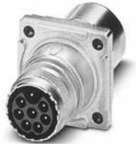
Wanddurchführung, gerade, SPEEDCON, M17, Polzahl: 7+PE, Kontaktart: Stift, Flachdichtung, 4x Ø 3,2, geschirmt: ja, Flanschmaß: 25,75 mm x 25,75 mm, Schutzart: IP67, Kabeldurchmesserbereich: 9 mm ... 11 mm, Polzahl: 8, Anschlussart: Crimpanschluss, Serie: ST, Alternativprodukt nach RoHS II ohne Ausnahme 6c (Pb < 0,1 %) Art.-Nr.: 1243334
