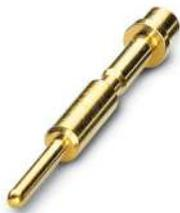
Crimpkontakt, gedreht, Einzelkontakt, Kontaktdurchmesser: 1 mm, Crimpbereich: 0,06 mm<sup>2</sup> ... 0,25 mm<sup>2</sup>, Alternativprodukt nach RoHS II ohne Ausnahme 6c (Pb < 0,1 %) Art.-Nr.: 1243215
