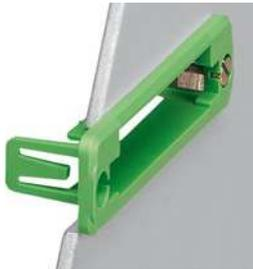
Anbaurahmen, Nennquerschnitt: 2,5 mm<sup>2</sup>, Farbe: grün, Anzahl der Potenziale: 2, Anzahl der Reihen: 1, Polzahl: 2, Anzahl der Anschlüsse: 2, Artikelfamilie: IC-DFR, Rastermaß: 5,08 mm, Verpackungsart: verpackt im Karton, Dieser Montagerahmen ist nur in Kombination mit IC 2,5/...-STGF-5,08 zu verwenden
