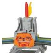
Die Prüfsteckerleisten lassen sich zum Prüfvorgang – auch bei angeschlossenen Leitern – auf die Klemmenleiste auf-schnappen. Da die Kontaktierung per Tippkontakt an den CAGE CLAMP®-Anschluss aus Federstahl erfolgt, bleibt diese Prüfmethode auf einen Nennstrom bis maximal 0,5 A beschränkt.
