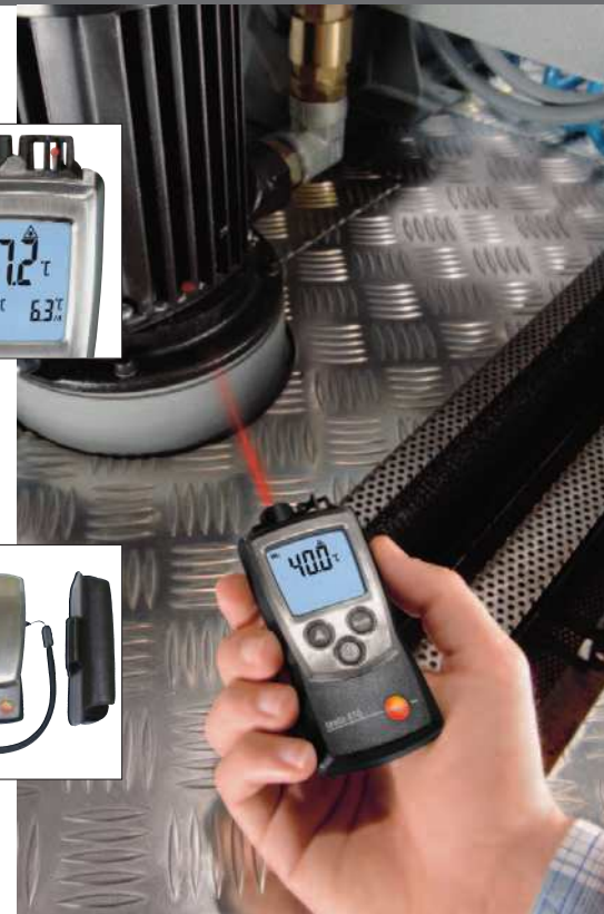
Überprüfen der Oberflächentemperatur, z.B. Elektromotor
