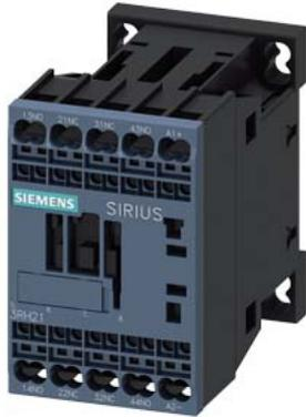
Hilfsschütz für Bahn 2S + 2Ö, DC 72-125V, 0,7...1,25\*US, mit integriertem Varistor Baugröße S00, Federzuganschluss geeignet für SPS-Ausgänge
