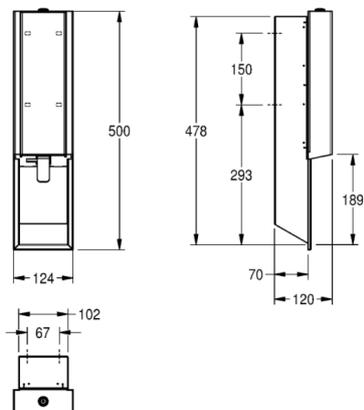
Schaumseifenspender für Unterputzmontage, Chromnickelstahl, Oberfläche seidenmatt, Front und Gehäuse mit InoxPlus Oberflächenveredelung zur Reduzierung von Fingerabdrücken und besseren Reinigungseigenschaften (easy to clean), Materialstärke 1,2 mm, mit Edelstahlzughebel, geeignet für Franke Schaumseife, inklusive Befestigungsmaterial und 650 ml Franke Schaumseife.
