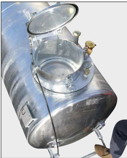
Der Einfülltrichter mit Grobeinsatz hat ein Fassungsvermögen von ca. 30 Liter.
