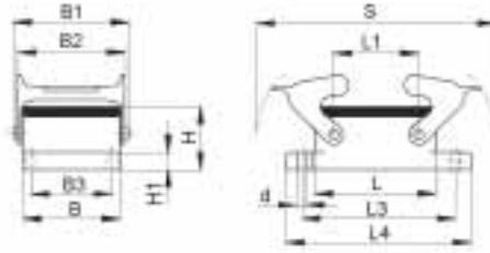
**EPIC® H-B Gehäuse: Anbaugehäuse (Querbügel)**
