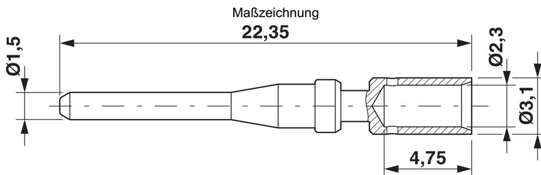
Crimpkontakt, Durchmesser: 1,5 mm
