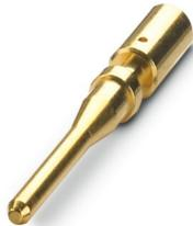
Crimpkontakt, Kontaktdurchmesser: 1,5 mm, gedreht, Stift, Material Kontakt: CuZn, Kontaktoberfläche: Ni/Au, Anschlussquerschnitt: 2,5 mm<sup>2</sup> ... 2,5 mm<sup>2</sup>, AWG 14 ... 14, für den PE- oder FE-Anschluss
