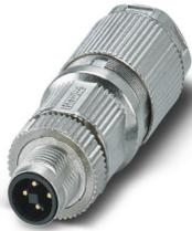
Power-Steckverbinder, Leistung, 4-polig, geschirmt, Stecker gerade M12, Kodierung: T, Crimpanschluss, Rändelmaterial: Zinkdruckguss, verzinkt, Leitungsaußendurchmesser 6,5 mm ... 11 mm, ohne Crimpkontakte, Kontakt 4 voreilend
