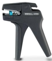
Abisolierwerkzeug, für Leiter und Kabel von 0,08 bis 2,5 mm Leiterquerschnitt, selbstjustierend, Abisolierlänge einstellbar bis 15 mm, Schneidvermögen bis 6 mm<sup>2</sup> flexibel / 1,5 mm<sup>2</sup> starr
