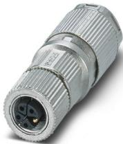
Power-Steckverbinder, Leistung, 5-polig, geschirmt, Buchse gerade M12, Kodierung: K, Crimpanschluss, Rändelmaterial: Zinkdruckguss, verzinkt, Leitungsaußendurchmesser 8 mm ... 13 mm, ohne Crimpkontakte, Kontakt 5 voreilend
