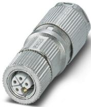
Power-Steckverbinder, Leistung, 5-polig, geschirmt, Buchse gerade M12, Kodierung: L, Crimpanschluss, Rändelmaterial: Zinkdruckguss, verzinkt, Leitungsaußendurchmesser 8 mm ... 13 mm, ohne Crimpkontakte, Kontakt 5 voreilend
