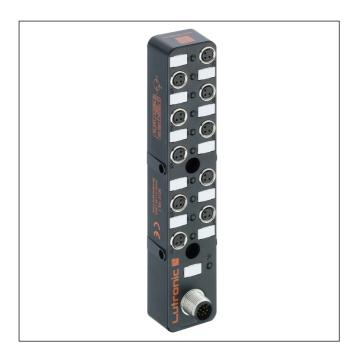
Passiver M8-Verteiler, 10-fach, Signal einfach, mit LEDs, IP67
