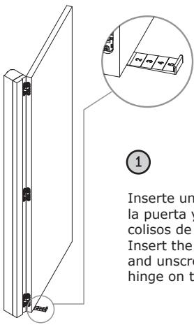
Inserte una cuña de regulación debajo de la puerta y afloje los tornillos B de los colisos de regulación.
