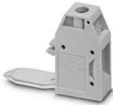
Abgriffklemme, Nur in Kombination mit UKH 50/70 verwendbar, Nennspannung: 1000 V, Nennstrom: 57 A, Anschlussart: Schraubanschluss, Bemessungsquerschnitt: 10 mm<sup>2</sup>, Querschnitt: 0,5 mm<sup>2</sup> - 10 mm<sup>2</sup>, Farbe: grau
