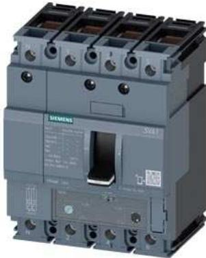
Leistungsschalter 3VA1 IEC Frame 160 Schaltvermögenklasse M Icu=55kA @ 415V 4-polig, Anlagenschutz TM240, ATAM, In=100A Überlastschutz Ir=70A...100A Kurzschlusschutz Ii=5...10 x In N-Leiterschutz 100% Klemmenanschluss
