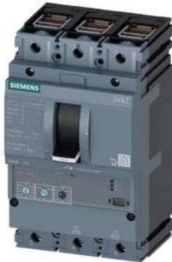
Leistungsschalter 3VA2 IEC Frame 160 Schaltvermögenklasse C Icu=110kA @ 415V 3-polig, Motorschutz ETU350M, LSI, In=25A Überlastschutz Ir=10A...25A Kurzschlusschutz Isd=3...15 x Ir, li=15 x In Klemmenanschluss
