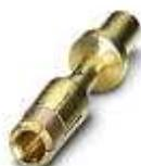
Crimpkontakt, gedreht, Einzelkontakt, Kontaktdurchmesser: 3,6 mm, Crimpbereich: 2,5 mm<sup>2</sup> ... 4 mm<sup>2</sup>
