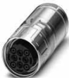
Kabelsteckverbinder, gerade, SPEEDCON-Verriegelung, M40, Polzahl: 2+3+PE, Kontaktart: Buchse, Crimpanschluss, geschirmt: ja, Kabeldurchmesserbereich: 20,5 mm ... 26,5 mm
