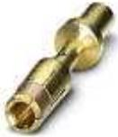
Crimpkontakt, gedreht, Einzelkontakt, Kontaktdurchmesser: 3,6 mm, Crimpbereich: 6 mm<sup>2</sup> ... 10 mm<sup>2</sup>
