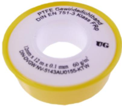
PTFE Gewindedichtband DVGW, "Teflonband", zugelassen für Gas- und Trinkwasserleitungen, DIN EN 751-3 Klasse FRp, 60 g/m<sup>2</sup>
