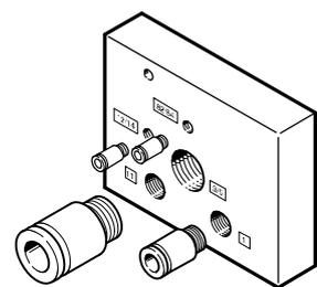
Beispiel einer Endplatte: Das Bild zeigt eine Endplatte links mit externer Steuerluftversorgung. Die Entlüftungsanschlüsse 3/5 und 82/84 können mit Verschraubung oder Schalldämpfer
