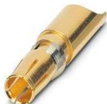
Power-Kontakte, für D-SUB-Kombinationseinsätze, Buchse, Lötkehl gerade, Bemessungsstrom 40 A, vergoldet
