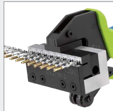
Werkzeug zum Abtrennen der Einzelkontakte von Bandware
