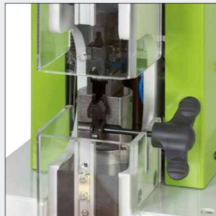
Crimpsmaschine CM 25-2 zum Verarbeiten geschirmter Steckverbinder
