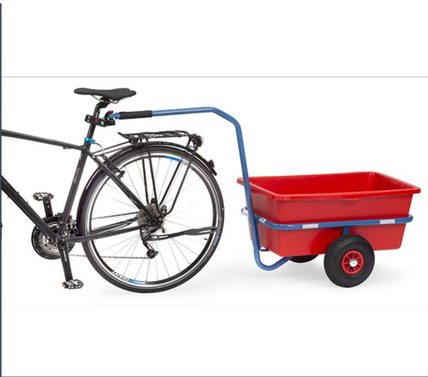
Fahradkupplung für Handwagen 4091, 4092, 4101 und 4102. Bestehend aus einer Deichsel mit Kugelschale, Kugelkupplung und Adapter für Sattelstützen von 26 bis 31 mm Durchmesser. Zuladung max. 40 kg, Aufliege­last max. 4 kg. Nicht nachrüstbar. Für Handwagen mit Fahrradkupplungen werden Folienreflektorstreifen kostenlos mitgeliefert. 2 x rot und 4 x weiß.
