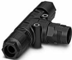
T-Verteiler, QUICKON-Anschluss, Polzahl: 4+PE, 0,5 mm<sup>2</sup> ... 1,5 mm<sup>2</sup>, 690 V, 17,5 A, schwarz, mit zwei QUICKON-Muttern, Leitungsaußendurchmesser: 10 mm ... 14 mm
