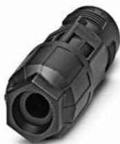
Leitungsverbinder, QUICKON-Anschluss, Polzahl: 4+PE, 0,5 mm<sup>2</sup> ... 1,5 mm<sup>2</sup>, 690 V, 17,5 A, schwarz, mit einer QUICKON-Mutter, Leitungsaußendurchmesser : 6 mm ... 10 mm, QUICKON-Schnellanschluss
