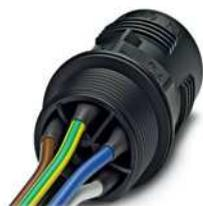
Wanddurchführung, QUICKON-Anschluss, Polzahl: 4+PE, 0,5 mm<sup>2</sup> ... 1,5 mm<sup>2</sup>, 690 V, 17,5 A, schwarz, ohne QUICKON-Mutter, Montagegewinde: M25, Einzeladern (angeschweißt), 1,5 mm<sup>2</sup>, Adern glatt abgeschnitten, Leitungslänge: 0,5 m
