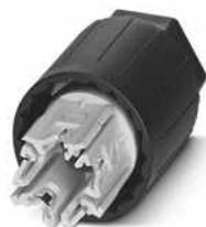
Mutter, QUICKON-Anschluss, Polzahl: 4+PE, 0,5 mm<sup>2</sup> ... 1,5 mm<sup>2</sup>, 690 V, 17,5 A, schwarz, Leitungsaußendurchmesser: 10 mm ... 14 mm
