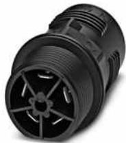
Wanddurchführung, QUICKON-Anschluss, Polzahl: 4+PE, 0,5 mm<sup>2</sup> ... 1,5 mm<sup>2</sup>, 690 V, 17,5 A, schwarz, ohne QUICKON-Mutter, Montagegewinde: M25, Flachsteckanschluss (für Flachsteckhülsen nach DIN 46247-2), 1,5 mm<sup>2</sup>
