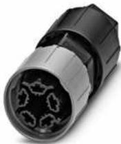
Steckverbinder, QUICKON-Anschluss, Polzahl: 4+PE, 0,5 mm<sup>2</sup> ... 1,5 mm<sup>2</sup>, 690 V, 17,5 A, schwarz, mit QUICKON-Mutter, Leitungsaußendurchmesser: 10 mm .. . 14 mm
