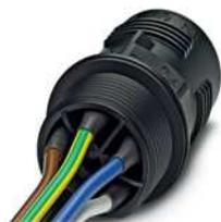
Wanddurchführung, QUICKON-Anschluss, Polzahl: 4+PE, 0,5 mm<sup>2</sup> ... 1,5 mm<sup>2</sup>, 690 V, 17,5 A, schwarz, ohne QUICKON-Mutter, Montagegewinde: M25, Einzeladern, 1,5 mm<sup>2</sup>, Leitungslänge: 1 m
