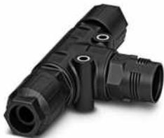
T-Verteiler, QUICKON-Anschluss, Polzahl: 4+PE, 0,5 mm<sup>2</sup> ... 1,5 mm<sup>2</sup>, 690 V, 17,5 A, schwarz, mit zwei QUICKON-Muttern, Leitungsaußendurchmesser: 6 mm ... 10 mm
