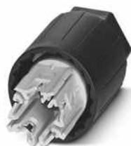
Mutter, QUICKON-Anschluss, Polzahl: 4+PE, 0,5 mm<sup>2</sup> ... 1,5 mm<sup>2</sup>, 690 V, 17,5 A, schwarz, Leitungsaußendurchmesser: 6 mm ... 10 mm
