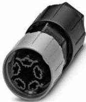
Steckverbinder, QUICKON-Anschluss, Polzahl: 4+PE, 0,5 mm<sup>2</sup> ... 1,5 mm<sup>2</sup>, 690 V, 17,5 A, schwarz, mit QUICKON-Mutter, Leitungsaußendurchmesser: 6 mm ... 10 mm
