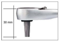
MICRO-Bit-Ratsche mit 1/4"-Sechskantaufnahme. Mit Magneteinsatz. Distanz vom Umschalthebel bis zur Bit-Spitze nur 30 mm. Mit extrem schlankem Kopf (23 x 12 mm). Feinverzahnt: mehrere der 72 Zähne rasten gleichzeitig ein und übertragen hohes Drehmoment. Umschalthebel für Rechts- und Linkslauf. Aus CrV-Stahl geschmiedet, 2 x vernickelt und mattverchromt. Griff aus öl- und säurefestem TPR (Thermoplastic Rubber). Gesamtlänge 120 mm.
