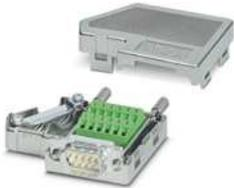
D-SUB-Stecker, 9-polig, Stift, zwei Kabelzuführungen unter 35°, Bussystem: MODBUS, MODBUS-PLUS, BITBUS, ARCNET, MULT/MININET (B&R), SYSTEM 2003 (B&R), P-NET, Pinbelegung: 1, 2, 3, 5, 6, 8 auf je zwei Schraubanschlussklemmen
