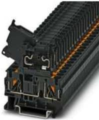
Sicherungsreihenklemme, Art der Sicherung: Glas / Keramik / ..., Sicherungstyp: G / 5 x 20, Nennspannung: 500 V, Nennstrom: 6,3 A, Polzahl: 1, Anschlussart: Push-in-Anschluss, Bemessungsquerschnitt: 4 mm<sup>2</sup>, Querschnitt: 0,2 mm<sup>2</sup>- 6 mm<sup>2</sup>, Montageart: NS 35/7,5, NS 35/15, Farbe: schwarz
