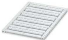
Marker für Klemmen, Matte, weiß, unbeschriftet, beschriftbar mit: TOPMARK NEO, TOPMARK LASER, BLUEMARK ID COLOR, BLUEMARK ID, BLUEMARK CLED, THERMOMARK PRIME, THERMOMARK CARD 2.0, THERMOMARK CARD, Montageart: verrasten, für Klemmenbreite: 6,2 mm, Schriftfeldgröße: 5,4 x 4,7 mm, Anzahl der Einzelschilder: 60
