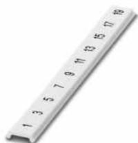
Zackband flach, Streifen, weiß, beschriftet, längs bedruckt: ungerade Zahlen 1-19, 21-39 usw. bis 81-99, Montageart: verrasten, für Klemmenbreite: 6,2 mm, Schriftfeldgröße: 5,15 x 6,15 mm, Anzahl der Einzelschilder: 10
