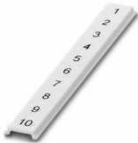
Zackband flach, Streifen, weiß, beschriftet, quer bedruckt: fortlaufende Zahlen 1 .. 10, 11 ... 20 usw. bis 91 ... 100, Montageart: verrasten, für Klemmenbreite: 5 mm, Schriftfeldgröße: 5,15 x 5,15 mm, Anzahl der Einzelschilder: 10
