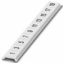
Zackband flach, Streifen, weiß, beschriftet, längs bedruckt: ungerade Zahlen 1-19, 21-39 usw. bis 81-99, Montageart: verrasten, für Klemmenbreite: 5 mm, Schriftfeldgröße: 5,15 x 5,15 mm, Anzahl der Einzelschilder: 10
