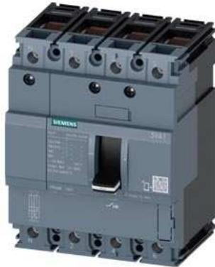
Leistungsschalter 3VA1 IEC Frame 160 Schaltvermögenklasse N Icu=25kA @ 415V 4-polig, Anlagenschutz TM210, FTFM, In=40A Überlastschutz Ir=40A fest eingestellt Kurzschlusschutz Ii=10 x In N-Leiter ungeschützt Klemmenanschluss
