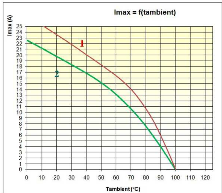
Fig. 2 Courbes thermiques & Choix dissipateur thermique / Thermal curves and heatsink choice
