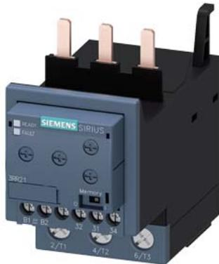
Überwachungsrelais, anbaubar an Schütz 3RT2, Baugröße S2 Basic, analog einstellbar Scheinstromüberwachung 8...80 A, 50...60 Hz, 2-phasig Versorgung 24 V AC/DC 1 Wechsler Überwachung auf Stromüber- und Unterschreitung Phasenausfall, Drahtbruch mit oder ohne Fehlerspeicher Anlaufverzögerung 0-60 s Störspitzenausblendung 0-30 s Schalthysterese 6% Schraubanschlusstechnik
