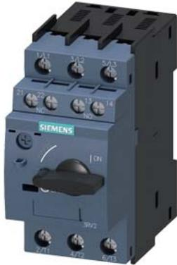
Sondertyp Leistungsschalter Baugröße S00 für den Motorschutz, CLASS 10 A-Auslöser 10...16 A N-Auslöser 208 A Schraubanschluss Standardschaltvermögen mit querliegenden Hilfsschalter 1S+1Ö Umgebungstemperatur -50 °C 500 Schaltspiele
