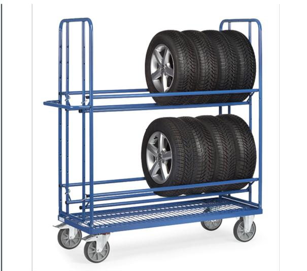
Stahlrohr-/Profilstahl-Konstruktion, pulverbeschichtet blau RAL 5007. Boden mit eingeschweißtem Drahtgitter 140 x 40 mm. Reifenträger variabel im Raster von 120 mm einhängbar, durch gelenkartige Aufhängung passen sich die Träger selbsttätig der Reifengröße an. 2 Lenk- und 2 Bockrollen mit TPE-Bereifung, Naben mit Rillenkugellager, Feststeller an den Lenkrollen.
