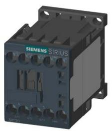
CONTACTOR, AC-3, 4KW/400V, 1NO, AC 220V 50HZ 240V 60 HZ, 3-POLE, SZ S00 SCREW TERMINAL
