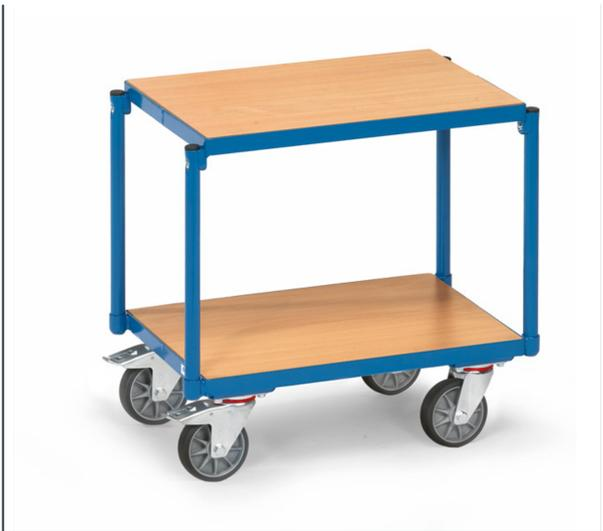
Etagen-Roller mit 2 Plattformen. Beide Rahmen mit Böden aus Holzwerkstoffplatte, Oberfläche Buchendekor. Böden bündig mit Oberkante Rahmen. Pulverbeschichtet blau RAL 5007. Lichter Etagenabstand 400 mm. Tragkraft obere Ladefläche 100 kg. 4 Lenkrollen mit TPE-Bereifung, Naben mit Rollenlager. 2 Stück mit Feststeller, gemäß der Europäischen Norm EN 1757-3 (Sicherheit von Plattformwagen). Passend für Eurokästen 600 x 400 mm. Zerlegte Anlieferung.
