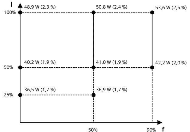
Die Prozentwerte geben die Verluste in Bezug auf die Bemessungsscheinleistung des Umrichters an.
