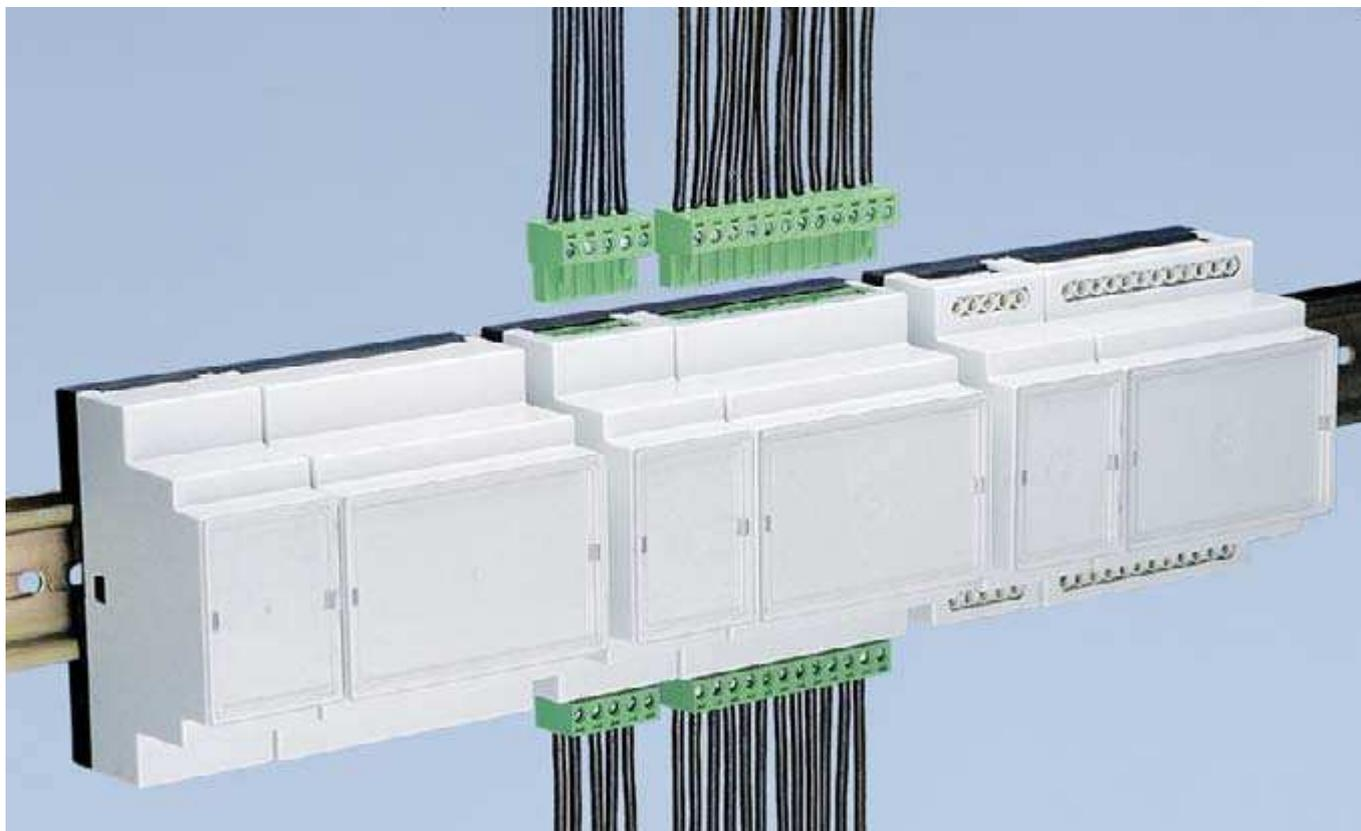
IDG-B Gehäuse werden vollständig aus Kunststoff hergestellt und sind daher vollisoliert. Sie erfüllen die relevanten modularen Einbaubedingungen, welche für vorhandenen Standards wie DIN 43880 (Einbaubehör; Gesamt- und Montageabmessungen) benötigt werden. Die Gehäuse haben unterschiedliche Einbaubreiten von 35 mm bis 157 mm.
