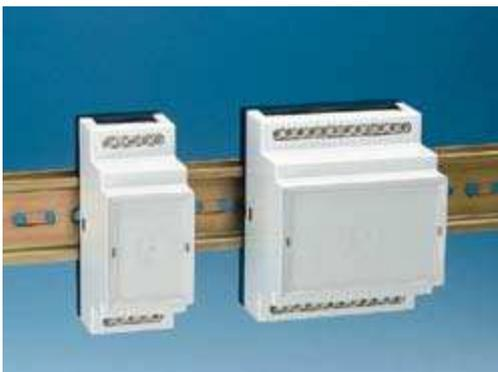
Diese Gehäuseversion ist konstruiert für den Kabelanschluss mit handelsüblichen Print-Schraubklemmen verschiedener Hersteller. Die Einzeladern können parallel zur Montageebene angeschlossen bzw. gelöst werden. Die Klemmschrauben sind optimalerweise senkrecht zur Montageebene zugänglich und mit Standard-Schraubendreher bedienbar.
