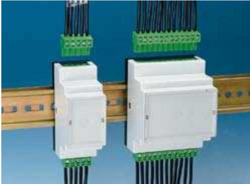
Diese Gehäuseversion ist konstruiert für den Anschluss von handelsüblichen steckbaren Schraubklemmen verschiedener Hersteller. Durch die steckbaren Schraubklemmen werden Verdrahtungsfehler beim Gerätetausch im Servicefall vermieden. Durch das steckbare System ist das vorverdrahten eines Schalt-schranks möglich.
