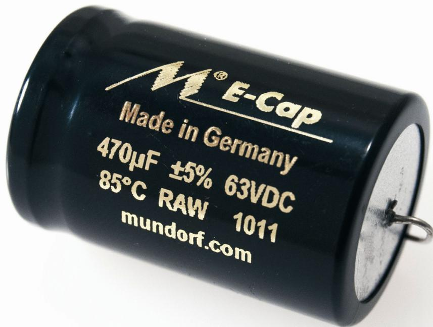
Aluminium-Elektrolytkondensatoren kommen überall da zum Einsatz, wo Filmkondensatoren aus Platz- und/oder Kostengründen nicht in Frage kommen. Bipolare Elektrolytkondensatoren, wie die ECap AC Serie, besitzen eine zweite Aluminiumfolie, welche sie wechsellspannungsfest und damit musiksingnaltauglich macht.
