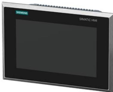
SIMATIC HMI TP900 Comfort INOX Edelstahlfront, Glasscheibe, kapazitiver Touch, Schutzart Front IP69K, 9" Widescreen-TFT-Display, PROFINET Schnittstelle, MPI/PROFIBUS-DP Schnittstelle, 12MByte Projektierungsspeicher, Windows CE 6.0, (Microsoft-Support inklusive Sicherheitsupdates eingestellt) projektierbar ab WinCC Comfort V15
