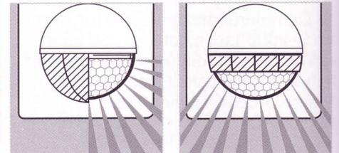
Abdeckblenden zur Reduzierung des Erfassungswinkels und der Reichweite
