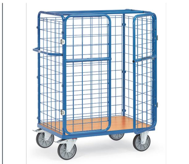
Ensemble mécano-soudé, revêtement époxy bleu RAL 5007. 1 plateau fixe en mélaminé surface effet hêtre. 3 côtés grillagés maille de 100 x 100 x 5 mm. Double porte battante, armature en tube habillée de treillis 100 x 100 x 5 mm. Verrou à douille intégré dans l'armature, portes rabattables sur les petits côtés. Hauteur 1552 mm. 2 roues pivotantes et 2 roues fixes à bandage TPE, moyeu à roulement à billes central. Freins sur roues pivotantes conformément à la Norme EN 1757-3.
