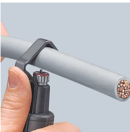
Posizionamento dell'utensile per taglio perimetrale
