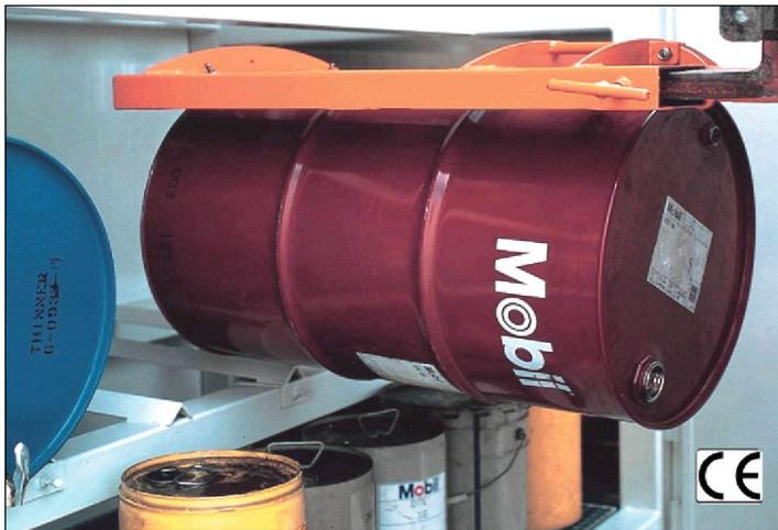
Heben und Transportieren von liegenden 200-l-Stahl-Spundfässern
