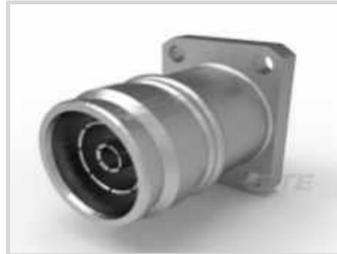
HF-Schnittstelle: **4.3-10**HF-Steckverbinder Ausführung: **Buchse**HF-Steckverbinder Außendurchmesser gesteckt (ca.): **32 mm [ 1.26 in ]**Impedanz: **50 Ω**HF-Steckverbinder-Kupplungsmechanismus: **Schraube**
