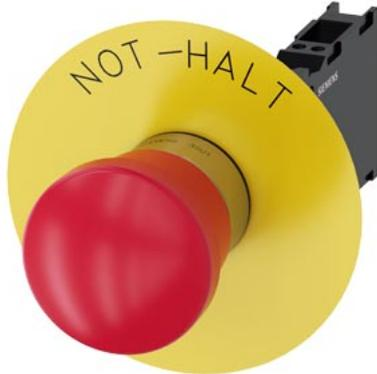
NOT-HALT-Pilzdrucktaster, 22 mm, rund, Metall, hochglanz, rot, 40 mm, zwangsläufige Verrastung, gemäß DIN EN ISO 13850, Zugentriegelung, mit gelbem Unterlegschild, Beschriftung: NOT-HALT, mit Halter, 1S+1Ö, Federzuganschluss
