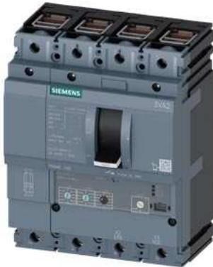
Leistungsschalter 3VA2 IEC Frame 160 Schaltvermögenklasse E Icu=200 kA @ 415 V 4-polig, Anlagenschutz ETU320, LI, In=100A Überlastschutz Ir=40A ... 100A Kurzschlusschutz Ii=1,5...12 x In N-Leiterschutz einstellbar (OFF,50%,100%) Klemmenanschluss
