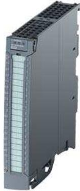
SIMATIC S7-1500, Digitaleingabemodul, DI 16xDC 24V BA, 16 Kanäle in Gruppen zu 16, Eingangsverzögerung typ. 3,2ms, Eingangstyp 3 (IEC 61131); Lieferung inkl. Frontstecker Push-In
