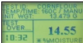
Display Anzeige in % Feuchte, %Trockensubstanz, Gewicht, Zeit, Temperatur, Trocknungskurve und mehr
