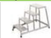
marchepied industriel, estrade hauteur x largeur x profondeur 800 x 520 x 305 mm, 4 marche(s) en tôle striée (estrade incl.), en aluminium
