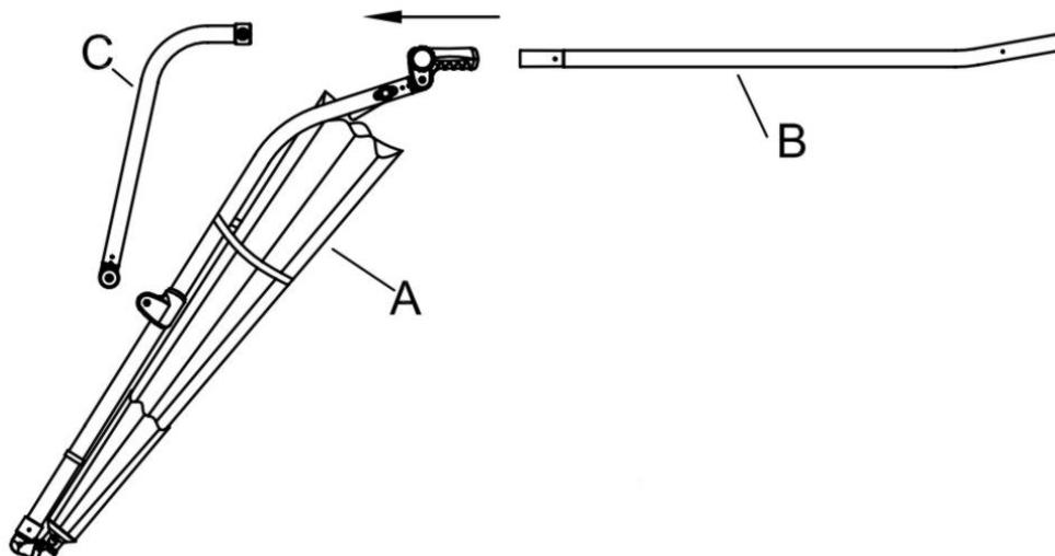
Nun den gebogenen Mastausleger **(C)** wie abgebildet mit dem Mast **(B)** verschrauben. Verwenden Sie dazu die Schraube M6 x 55 **(H)**.
